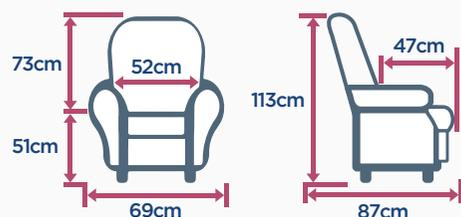
Profondeur d'assise repose-pieds allongé : 87 cm - Profondeur déployée : 179 cm
